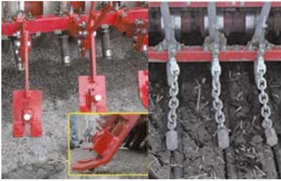
第1図 かき棒型覆土装置(左)と分銅型覆土装置(右)
